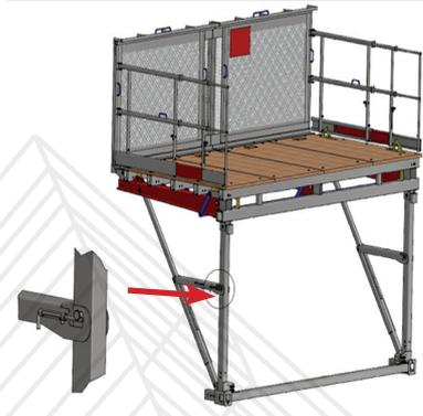
7 - Mettre en place le bracon horizontal et le verrouiller pour maintenir en sécurité la PTE dans sa position ouverte.
